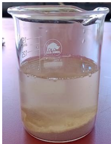
Figura 15 – Quitosana em solução de ácido acético 1% (v/v) para posterior dissolução.
