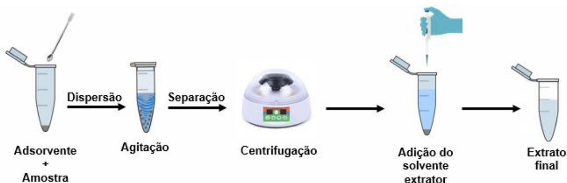
Figura 5 – Esquema da \mu -dSPE.
